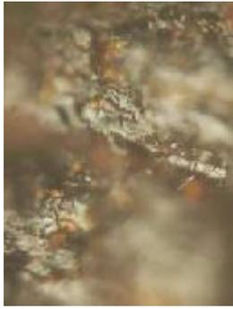
Figure 145 Cellules de rayons, en vue tangentielle, au microscope.
